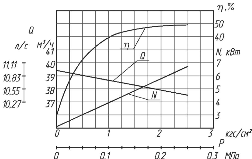
Характеристика электронасосных агрегатов (насосов) типа Ш80-2,5-37,5/2,5
